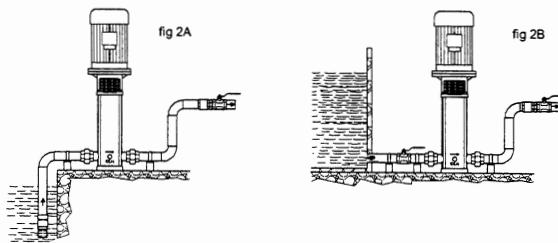
**ATENCIÓN:** Prever un espacio suficiente para la ventilación del motor, para controlar el sentido de giro del eje, para el llenado y vaciado de la bomba, y con la posibilidad de recoger el líquido sobrante.
