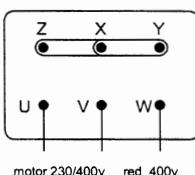
**ARRANQUE Y/Δ.** Quitar las plaquitas puente de la caja de bornes y conectar los bornes del motor con los correspondientes del arrancador.
