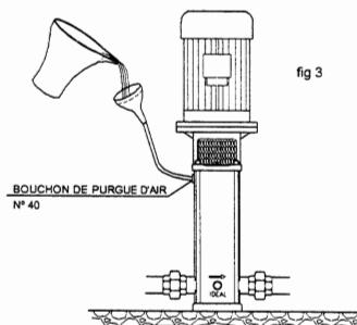
Après avoir effectué le branchement électrique et le remplissage, mettre la pompe en marche, avec la vanne de refoulement fermée et vérifier que le sens de rotation est correct (indique sur le corps de pompe) à travers la protection du manchon ou à travers le couvercle du ventilateur.
