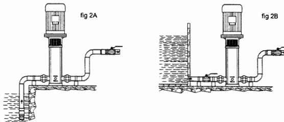
**ATTENTION:** Prévoir autour de la pompe l'espace pour la ventilation du moteur, pour les inspections sur la rotation de l'arbre, pour le remplissage et la vidange du corps de pompe, avec la possibilité de récupérer le liquide de vidange.
