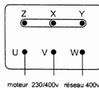
DÉMARRAGE Y/Δ. Enlever les plaquettes pont de la boîte à bornes et connecter les bornes du moteur avec les bornes correspondantes du démarreur.
